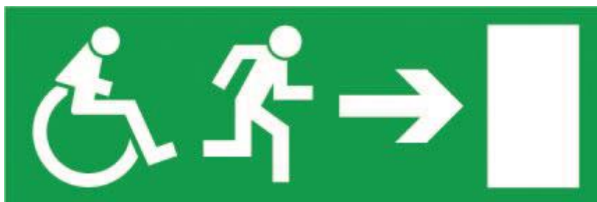
Figur 1. Skyltning till utrymningsplats och till tillgängliga utrymningsvägar i allmänhet i enlighet med Arbetsmiljöverket (AFS 2020:1).
