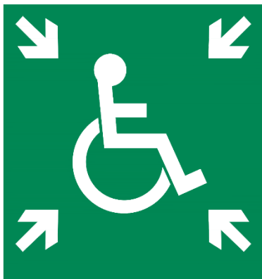
Figur 2 – skylt inom utrymningsplats enligt Arbetsmiljöverket (AFS 2020:1)
